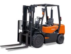
D20G / D25G / D30G 2,000kg 2,500kg 3,000kg Diesel, Pneumatic Tire
