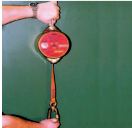
Bild 2-21: Höhensicherungsgerät mit Drahtseil
