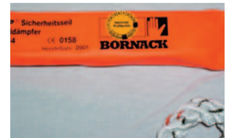
Bild 5-2: Kennzeichnung der Sachkundigenprüfung
