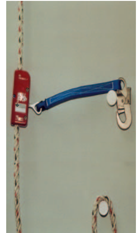
Bild 2-33: Mitlaufendes Auffanggerät (mit integriertem Falldämpfer)
