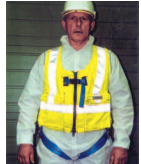
Bild 2-4: Auffanggurt im Overall integriert
