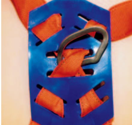
Bild 5-5: Beschädigung am Gurtmaterial
