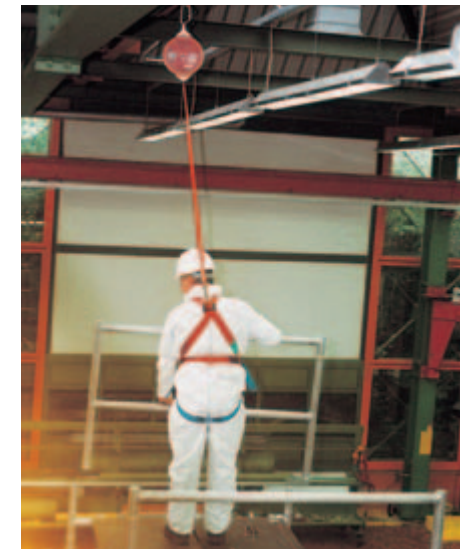
Bild 2-24: Höhensicherungsgerät im Einsatz
