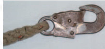
Bild 5-11: Stark korrodiertes Verbindungsmittel
