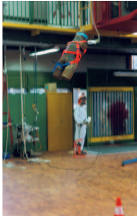
Bild 2-6: Fallversuch mit Prüftorso
