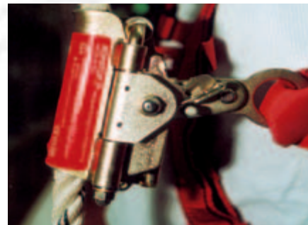
Bild 2-32: Kennzeichnung am mitlaufenden Auffanggerät auf Chemiefaserseil
