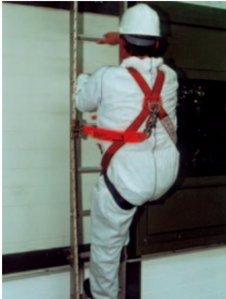
Bild 2-29: Mitlaufendes Auffanggerät an beweglicher Führung mit Bandfalldämpfer
