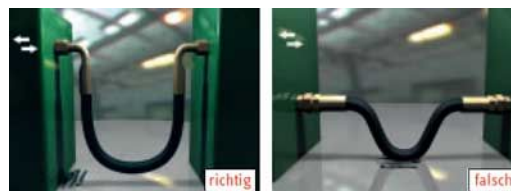
Abbildung 9: Vermeidung von Abrieb durch ausreichende Bewegungsfreiheit
