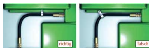
Abbildung 11: Einbau von Schlauchhalterungen
