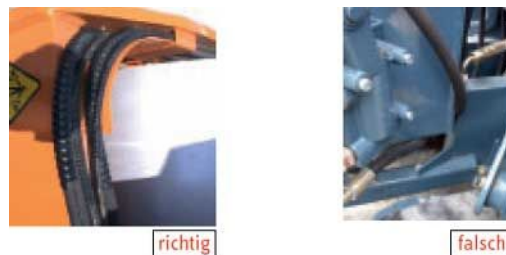
Abbildung 10: Vermeidung von Abknicken oder Scheuern
