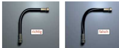
Abbildung 5: Torsion beim Einbau
